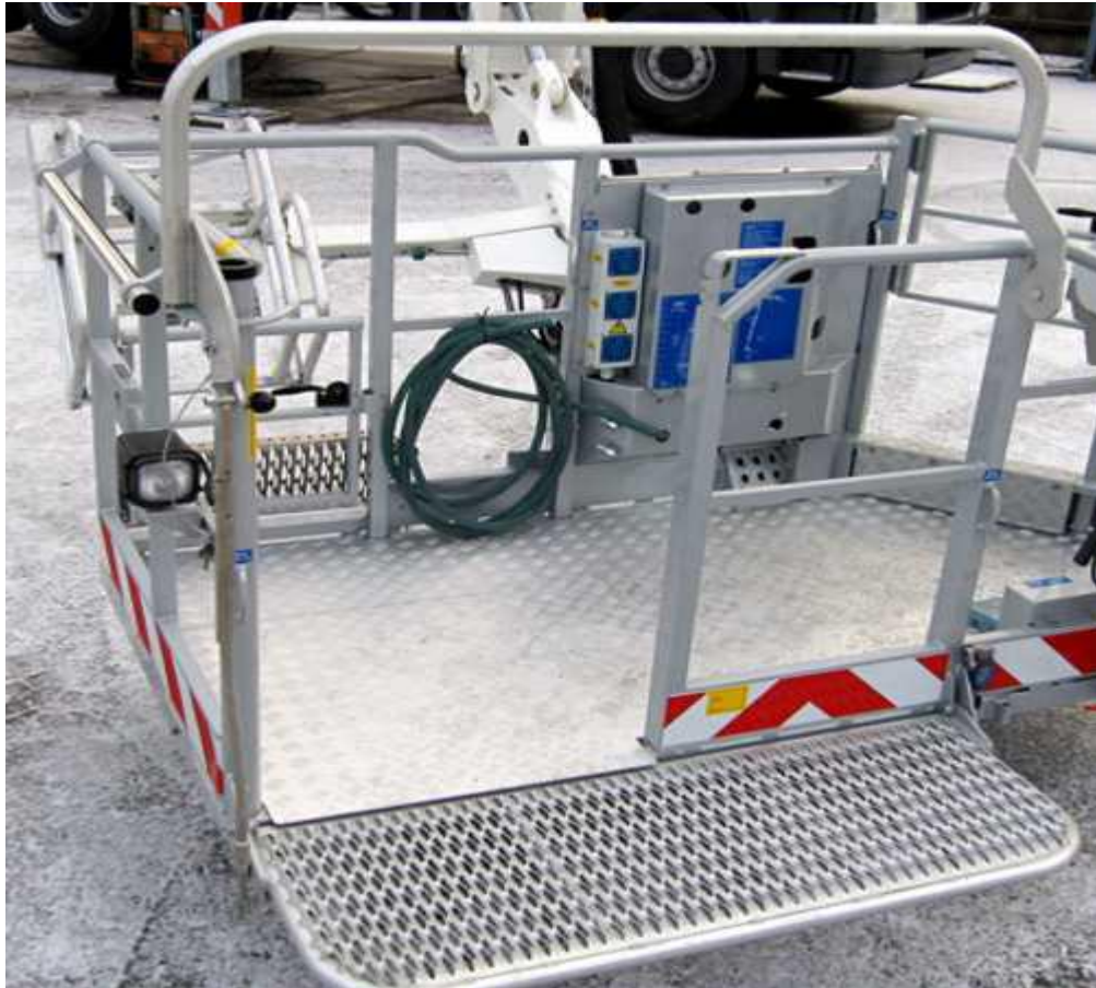
Figura 4. Balustrada de siguranță a platformei de salvare complet deschisă pentru a fi plasat un scaun cu roțile.
