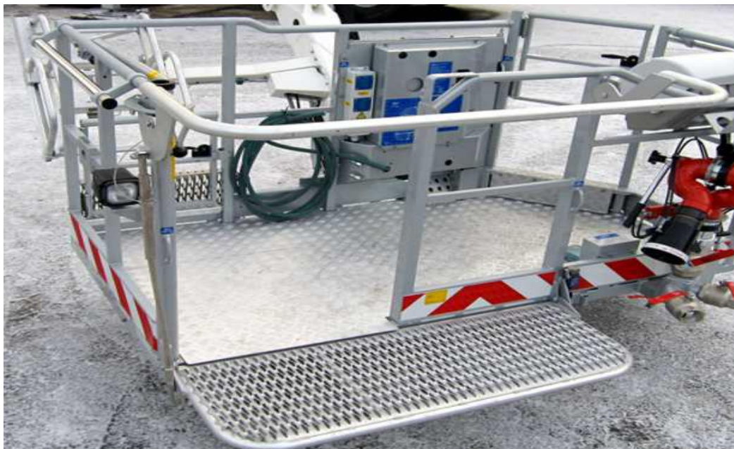
Figura 2. Rotirea balustradelor de siguranță și a platformei de salvare în poziție de salvare.
